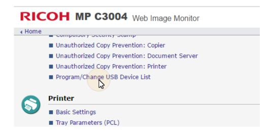
3. En la pestaña Programa/Cambiar lista de dispositivos USB, en la lista de dispositivos USB, introduzca la dirección del lector de tarjetas **ID de proveedor** y **Identificación del producto** y, a continuación, haga clic en **OK** en la esquina superior izquierda de la pestaña.
